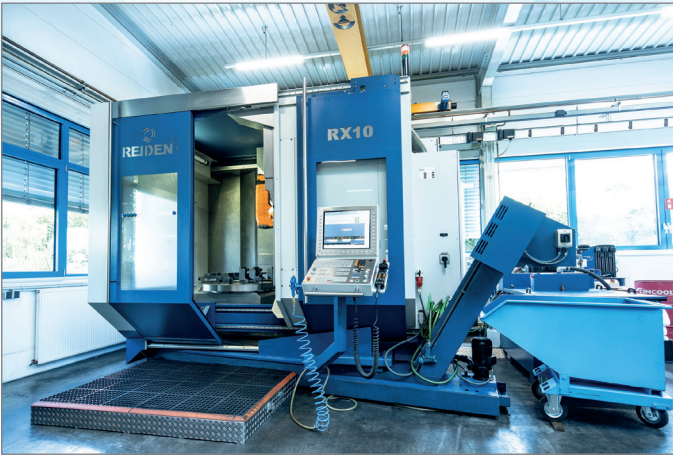
REIDEN RX 10 5-Achs Bearbeitungszentrum für komplexe Bauteile mit hoher Anforderung an Präzision
