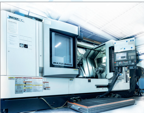
Dreh- / Fräszentrum Okuma B400 mit Haupt- und Gegenspindel
