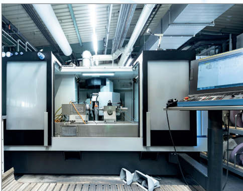
Kellenberger KEL 100 CNC Außen- / und Innenrund sowie Profil- und Unrundscheifen
